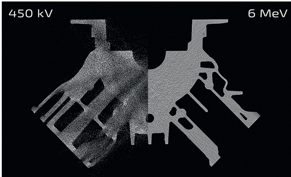
Bild 3. Durchstrahlungsvergleich: Der Scan einer V-Motorblocks mit 6 MeV und Linearbeschleuniger zeigt deutlich weniger Streustrahlung und erlaubt dadurch schnellere Auswertungen und führt auf zuverlässigere Ergebnisse. Quelle: diondo
